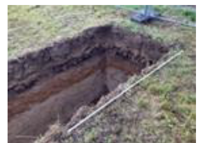
Schuttschicht im Erdreich
