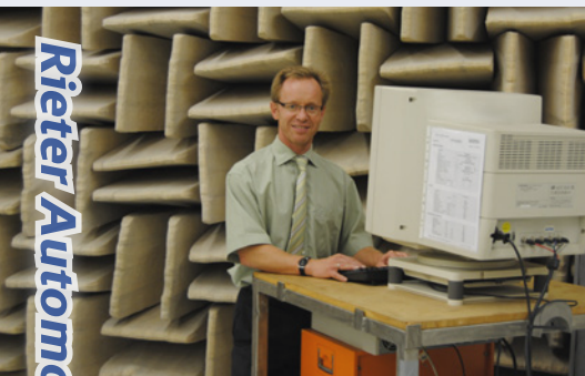
Geschäftsführer Dieter Krusche an einem Prüfstand in der fast schalltoten Akustikhalle. Hier wird das Sounddesign von Autos getestet und optimiert.
